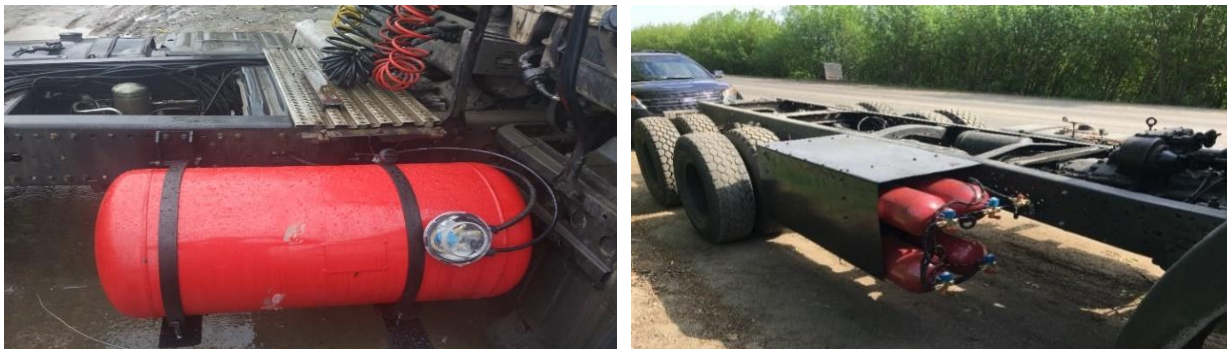
Зураг 3. ОХУ-д хүнд даацын автомашинд хийн тоног төхөөрөмж суурилуулсан байдал
